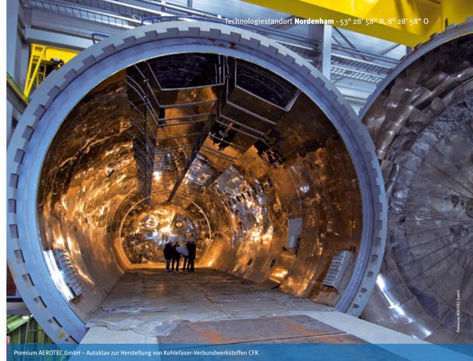
Premium AEROTEC GmbH – Autoklav zur Herstellung von Kohlefaser-Verbundwerkstoffen CFK
