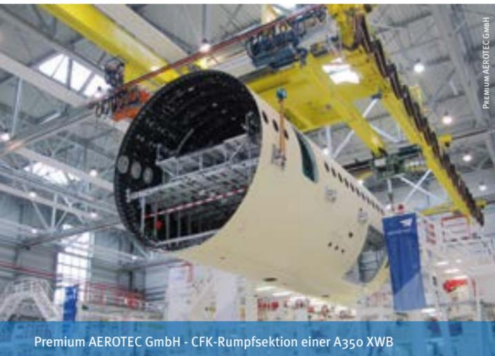
Premium AEROTEC GmbH - CFK-Rumpfsektion einer A350 XWB
