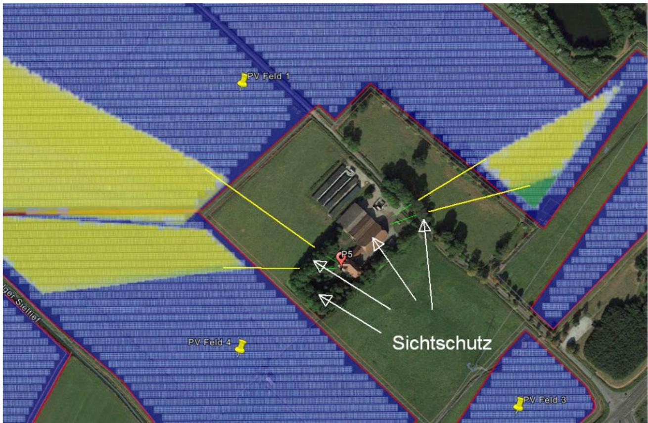
Bild 4.5.2: Simulation für Messpunkt P5 (Quelle: Google Earth/ SolPEG)
