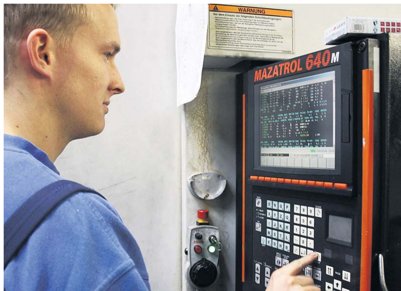
Daniel Kapmeyer programmiert die Maschinenanlage bei Drebelow und Jahn. Wenn alles gut geht, werden aus Metallklötzen Steuerblöcke. Foto yvo
